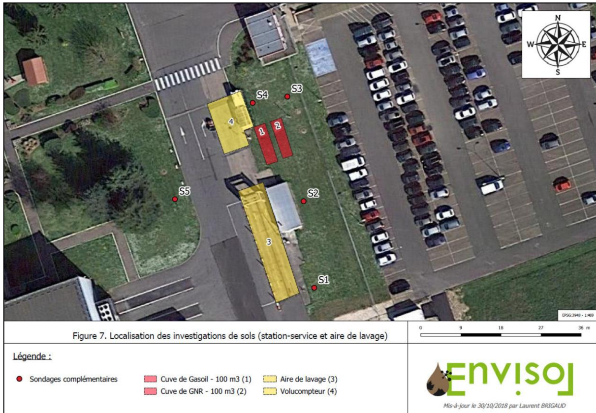
Figure 81 : Localisation des investigations supplémentaires au droit de la station-service et aire de lavage (Source : ENVISOL, 2019)
